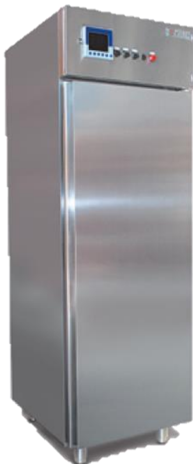
Figura 5. Ambiente di prova condizionato (armadio climatico).
